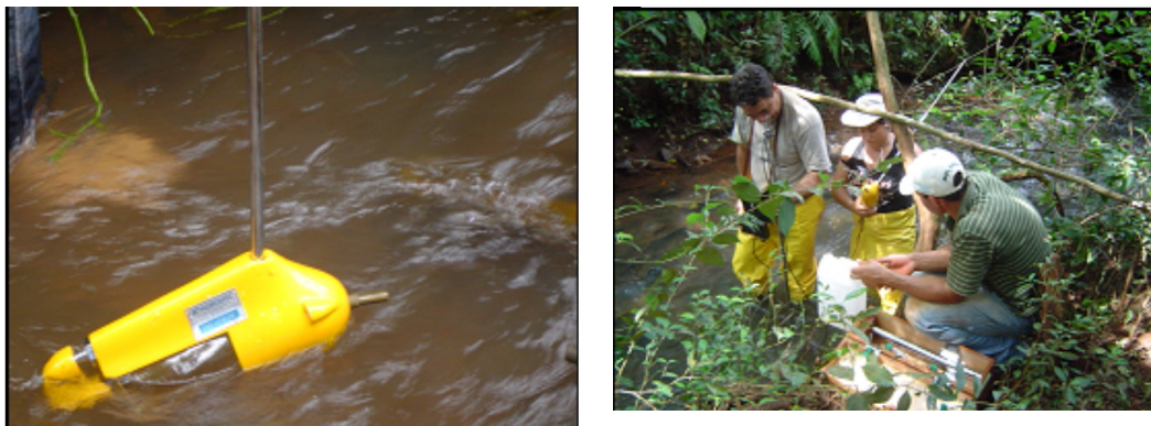
Figura 9 - Coleta da amostra de sedimentos em suspensão usando amostrador USDH-48.
