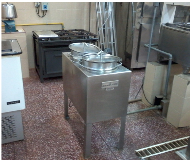
Figura 7 Fermenteira em aço inox de tamanho laboratorial, utilizada para o processo de fermentação.
