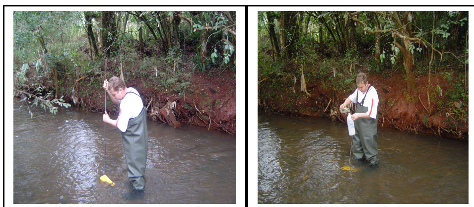
Figura 7 - Equipamento DH-48 para coleta de amostras de água na secção do rio.
