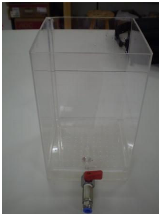
Figura 15 - Jarro para teste de flotação.
