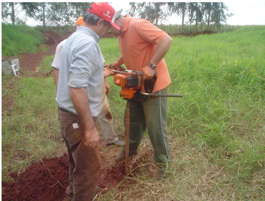
Figura 10 - Trado mecânico utilizado no aterro sanitário.
