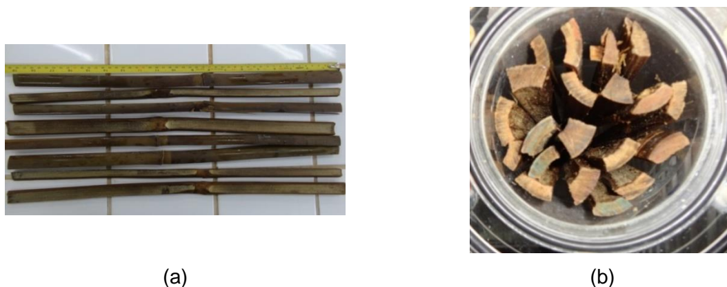
Figura 9 - (a) Hastes de bambu utilizadas no experimento, (b) meio suporte alocado dentro do reator.
