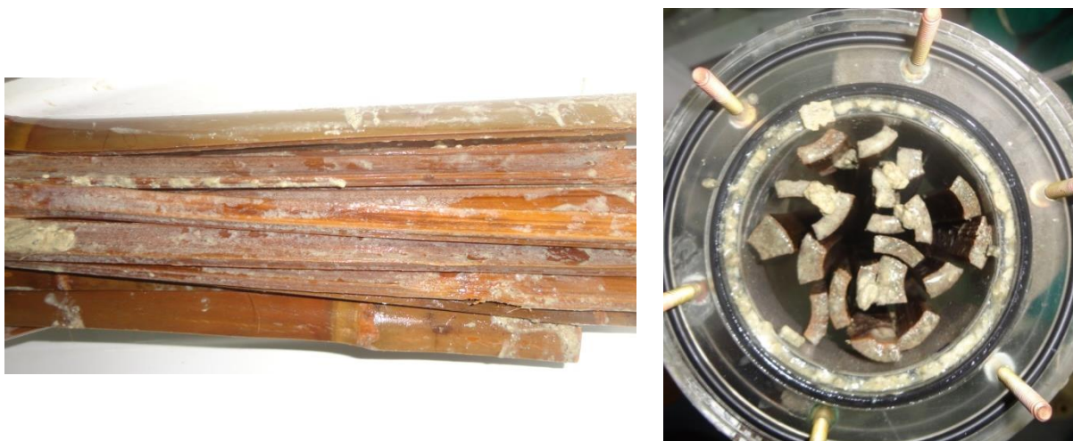
Figura 15 - Biomassa aderida no meio suporte.
