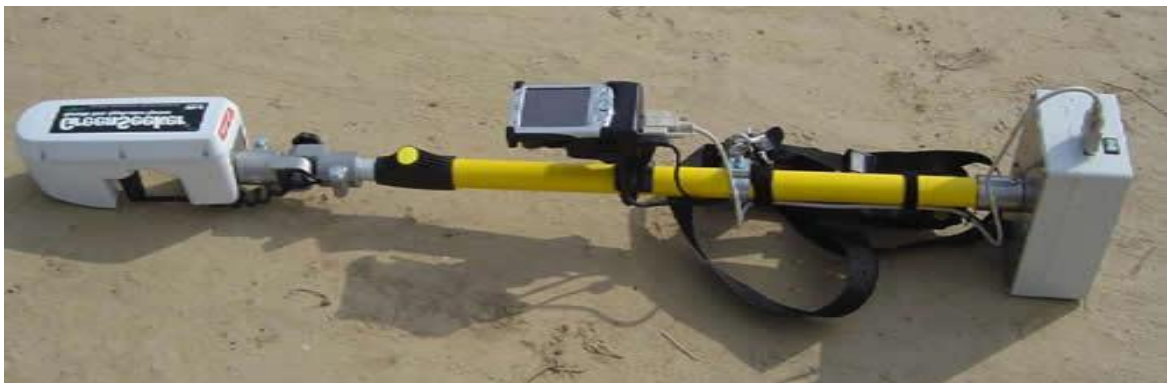
Figura 7 Medidor de índice de vegetação GreenSeeker.
