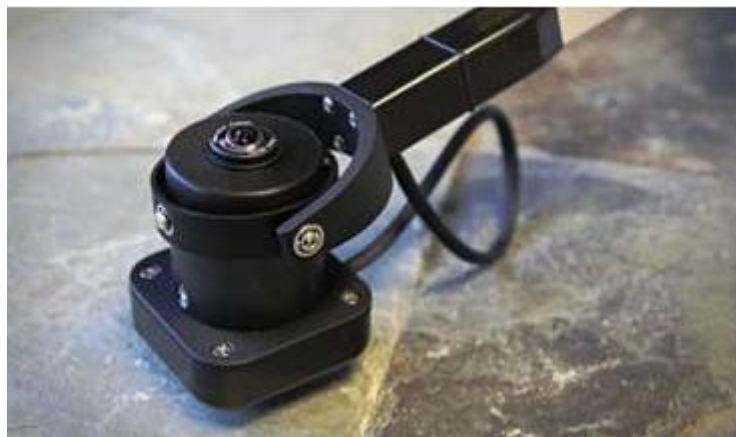
Figura 8 Medidor de índice de área foliar.
