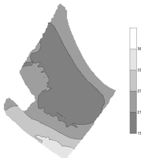
Figura 75 Mapa definido com “Mapa vinte e cinco passadas” criado pelo método de interpolação da krigagem para variável teor de água (%).
