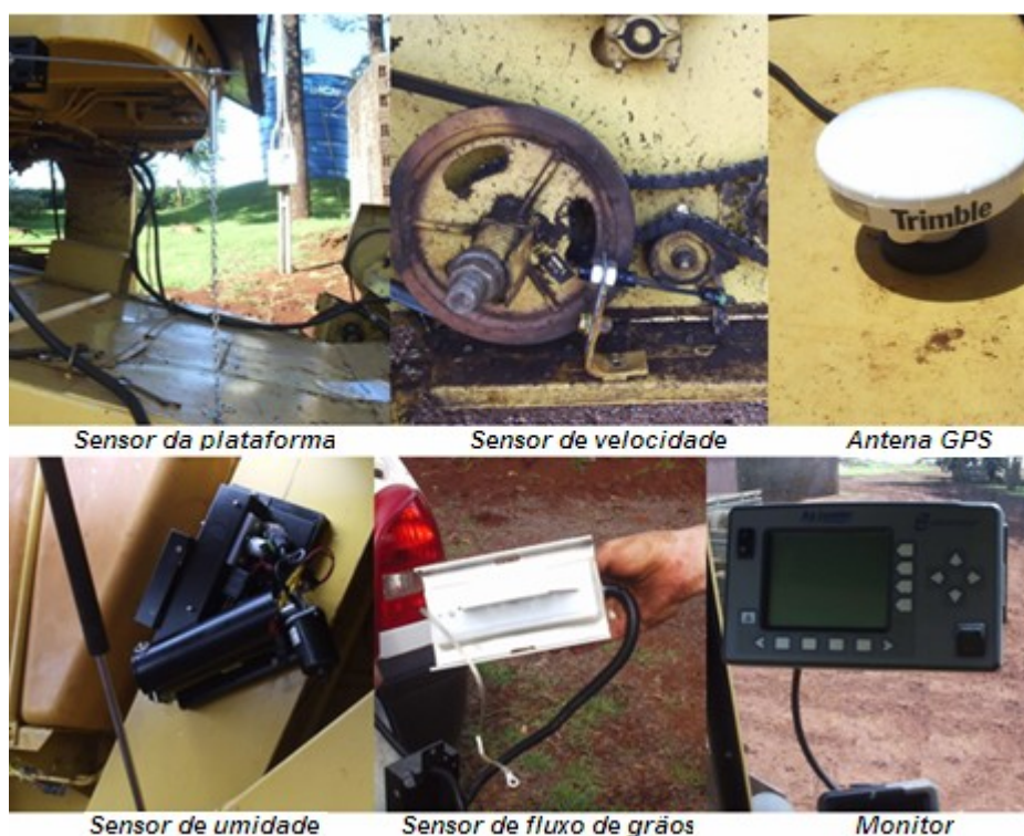
Figura 9 Dispositivos instalados na colhedora
