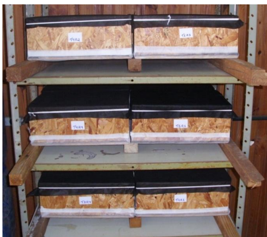
Figura 1 Vermireatores de madeira OSB.
