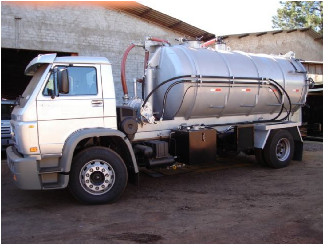
Figura 16 – Ilustração do equipamento (reservatório) e bomba lateral, instalado em caminhão semelhante ao escolhido
