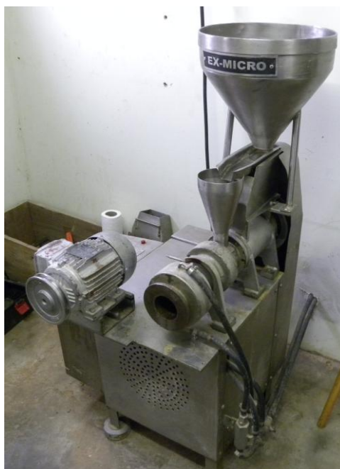
Figura 2. Equipamento utilizado para a extrusão das rações experimentais.
