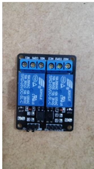
Figura 11 - Módulo rele de dois canais optoacoplado com tensão de operação em 5 volts.
