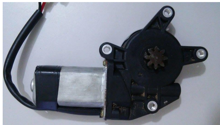
Figura 9– Motor automotivo universal de corrente contínua com operação em 12 volts e corrente de consumo de 4,9 amperes.
