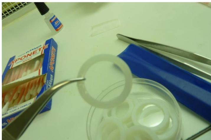
Figura 3.3. Anéis com filme kimfol para gotear as amostras.
