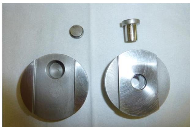
Figura 3.5. Pastilhador de aço inox – corpo e pistões inferior e superior.
