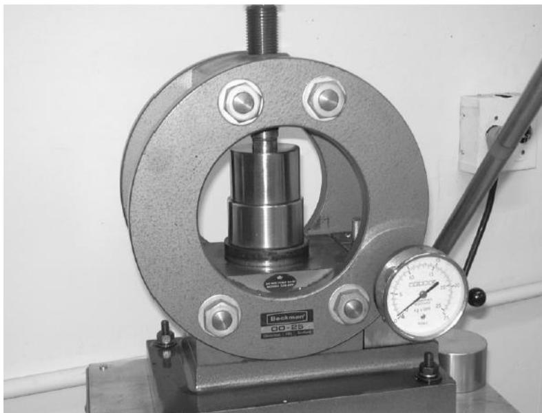
Figura 3.6. Pastilhador em processo de prensagem entre pistões.
