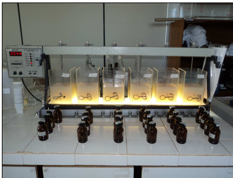
Figura 15: Ensaio de coagulação/floculação utilizando o equipamento de Jar-Test.
