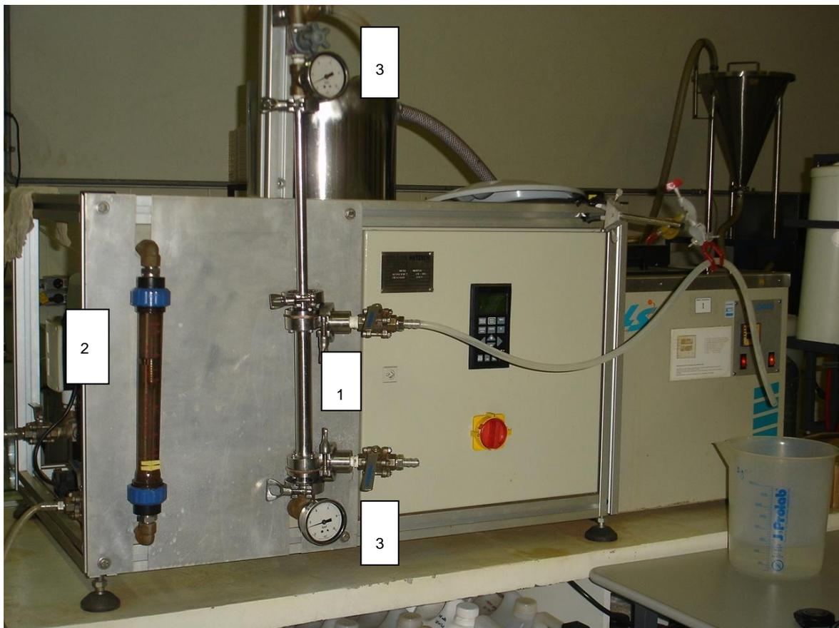
Figura 3.2. Unidade experimental de filtração por membranas (1 membrana; 2 rotâmetro; 3 manômetros).
