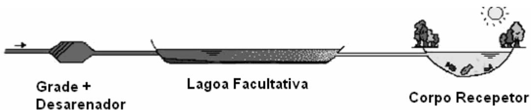
**Figura II.4** Esquema de um sistema de tratamento com lagoas facultativas.
