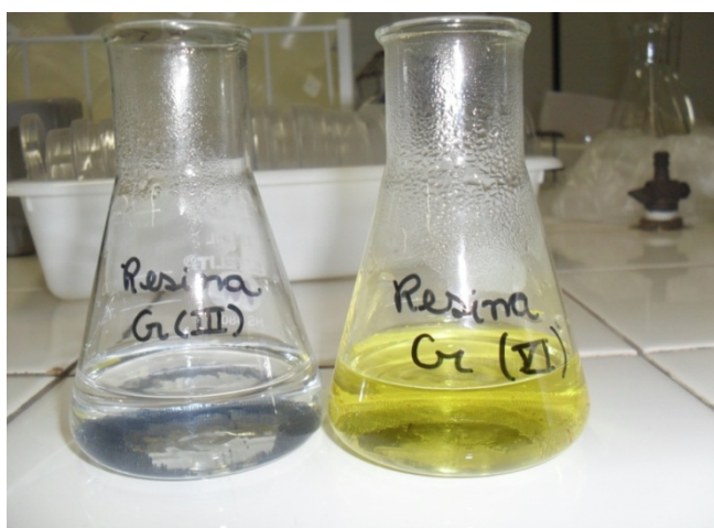
FIGURA 5.15 - Imagem frontal da resina catiônica após tratamento com soluções de Cr(III) e Cr(VI), respectivamente.
