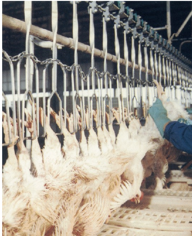
Figura 01 – Foto de uma nórea de pendura de frangos vivos. Fonte: Catálogo Linco.
