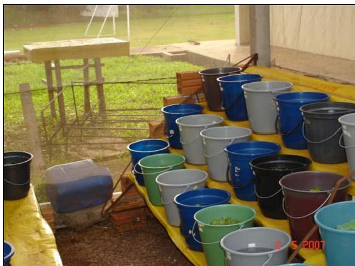
**Figura 3.2** - Montagem em estufa do experimento de bioacumulação de compostos de chumbo pela *S. auriculata*.
