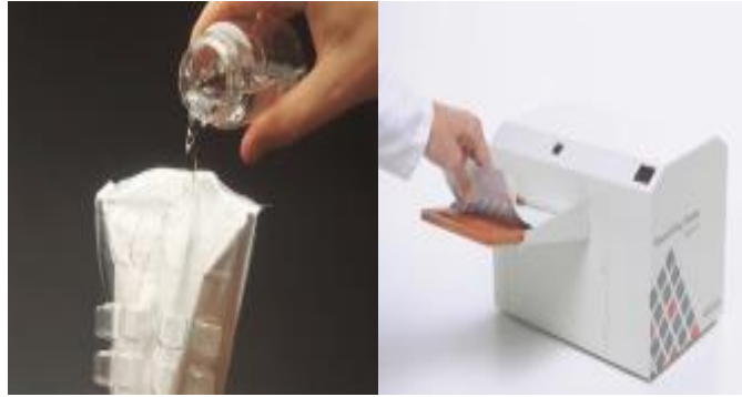
Figura 30. Cartela e incubador do método de análise bacteriológica Kit Colilert.
