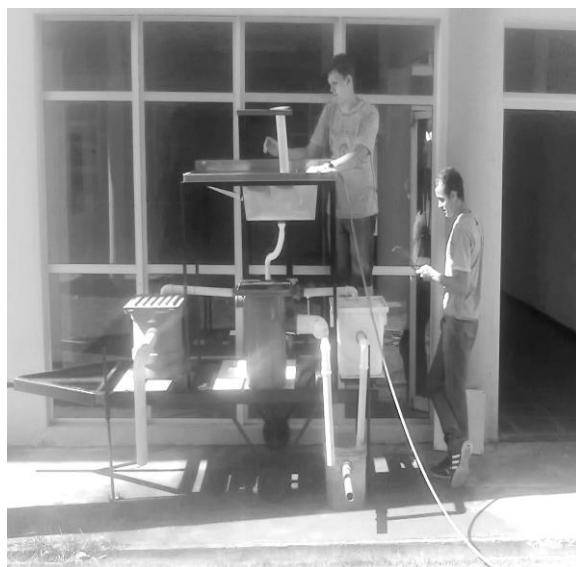
Figura 59. Esquema operacional do experimento para avaliação das eficiências das caixas de gordura.
