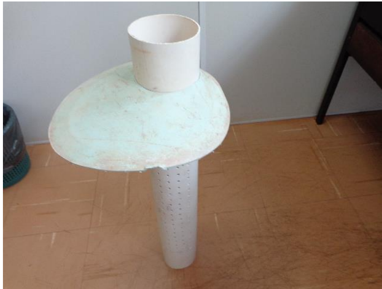
Figura 73. Protótipo do separador de efluentes do vaso sanitário.
