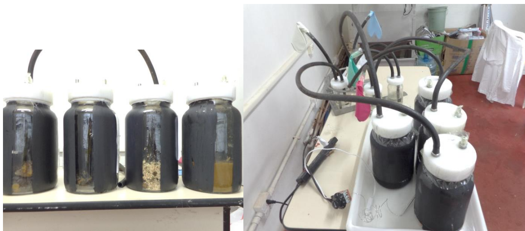
Figura 67. Módulo experimental desenvolvido para a definição dos parâmetros operacionais do biorreator anaeróbico.
