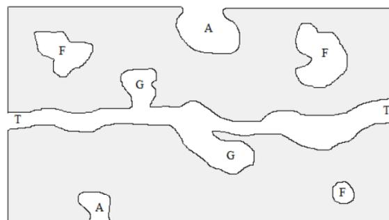
**Figura 2.2** Diferentes tipos de poros segundo a IUPAC. (A) poro aberto; (F) poro fechado; (T) poro de transporte; (G) poro tipo gaiola.
