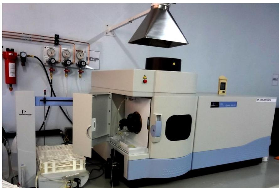
Figura 3.9 - Equipamento ICP-OES utilizado para quantificação elementar de amostras de água subterrânea.
