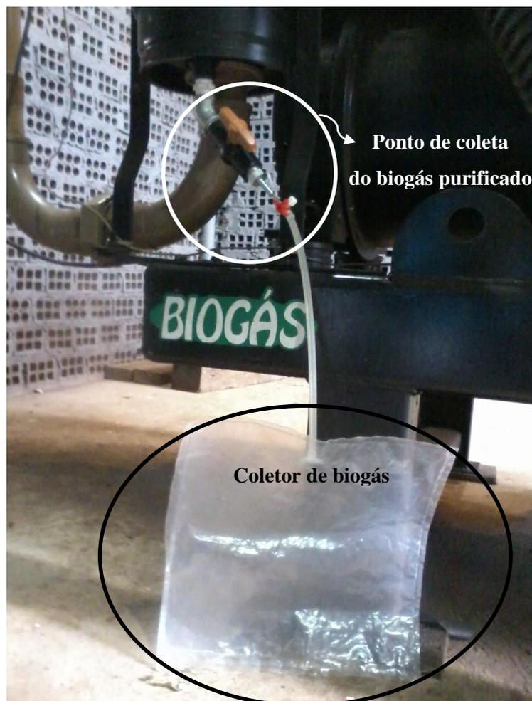
Figura 10. Coleta do biogás purificado na entrada do motor.
