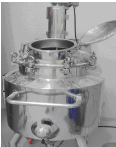
Figura 3.6. Tanque agitador utilizado para preparo de solução aglutinante no processamento de cloridrato de metformina 850mg.
