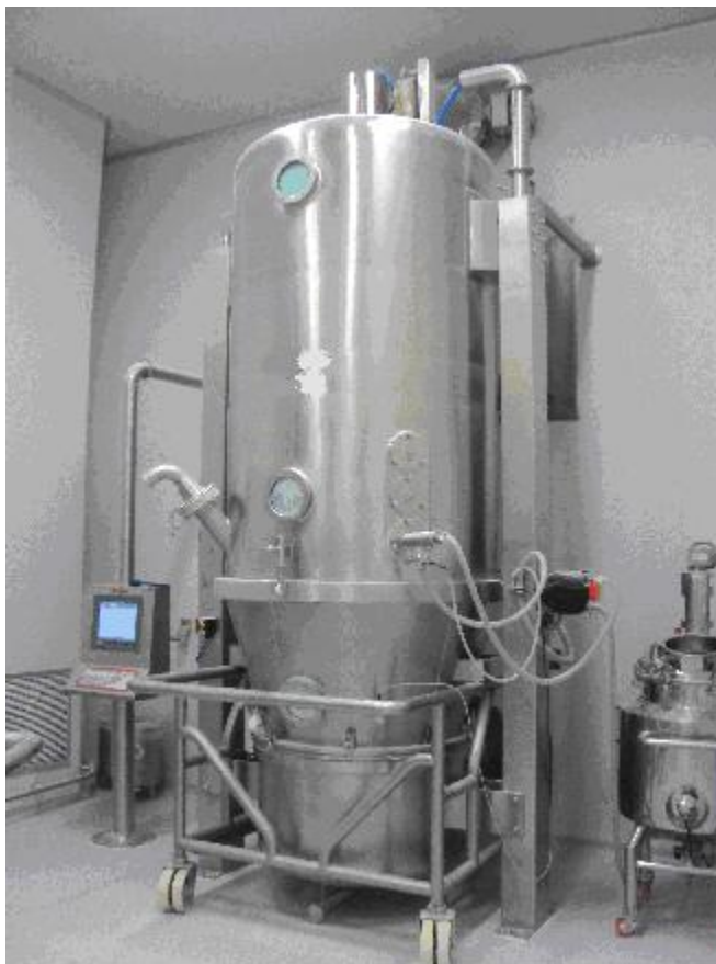
Figura 3.1. Equipamento de leito fluidizado utilizado em uma indústria farmacêutica.
