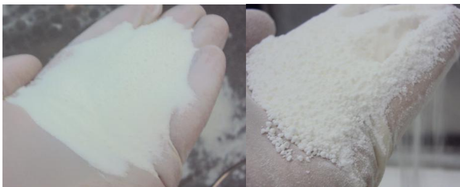
Figura 4.10. (a) granulato de cloridrato de metformina 850mg processado em leito fluidizado na velocidade de fluxo de ar de 1600\text{m}^3\cdot\text{h}^{-1} . (b) granulato de cloridrato de metformina 850mg processado em leito fluidizado na velocidade de fluxo de ar de 1000\text{m}^3\cdot\text{h}^{-1} .
