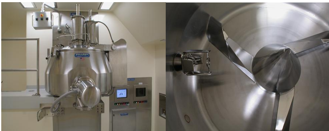
Figura 2.2. Equipamento High Shear Mixer . À esquerda, uma fotografia da parte externa do equipamento. À direita, uma fotografia da parte interna do equipamento: no centro a hélice que promove a mistura e na lateral o chopper ou picador, que promove o cisalhamento da massa formada, que promoverá a formação de grânulos mais resistentes. (HIGH shear mixer, http://www.fluidairinc.com/prod_hsm_features.shtml ).
