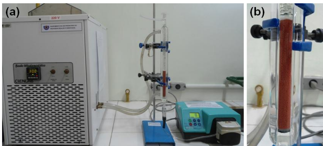
Figura 5.2 – Módulo experimental de adsorção em coluna de leito fixo: (a) Completo; (b) Leito fixo ampliado.
