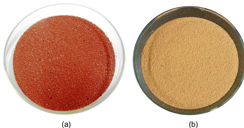
Figura 5.1 – Adsorvente Dowex™ Optipore™ SD-2: (a) antes da secagem; (b) após a secagem.
