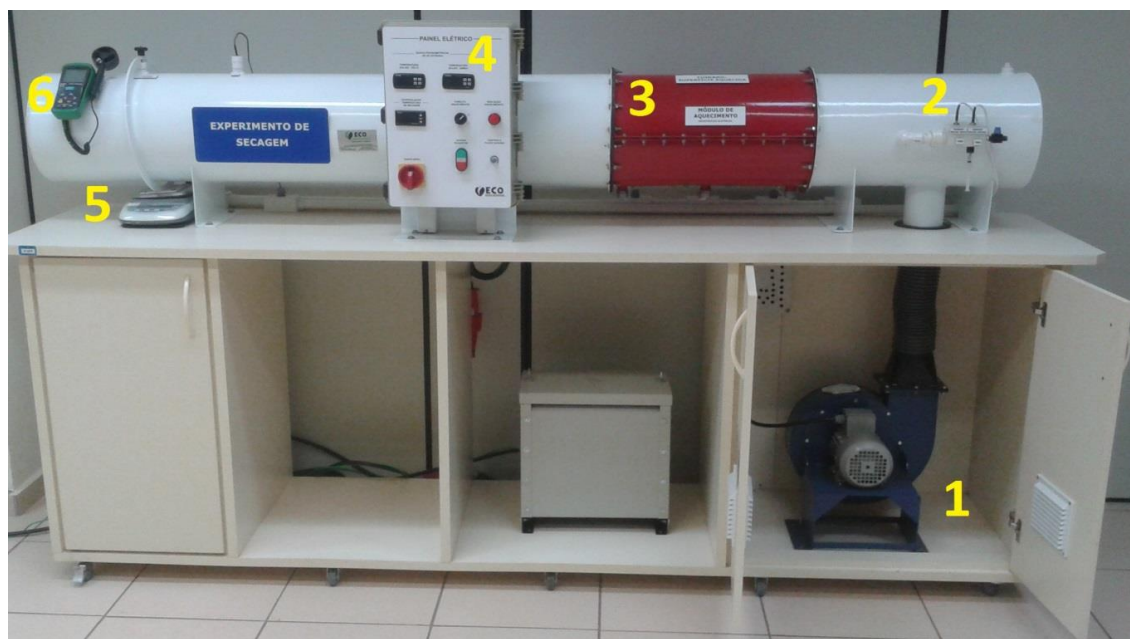
Figura 4. 6 - Módulo experimental de secagem convectiva. (1) Soprador de ar; (2) Psicrômetro; (3) Sistema de aquecimento; (4) Painele de controle; (5) Sistema de pesagem; (6) Anemômetro (BOFFO, 2013).
