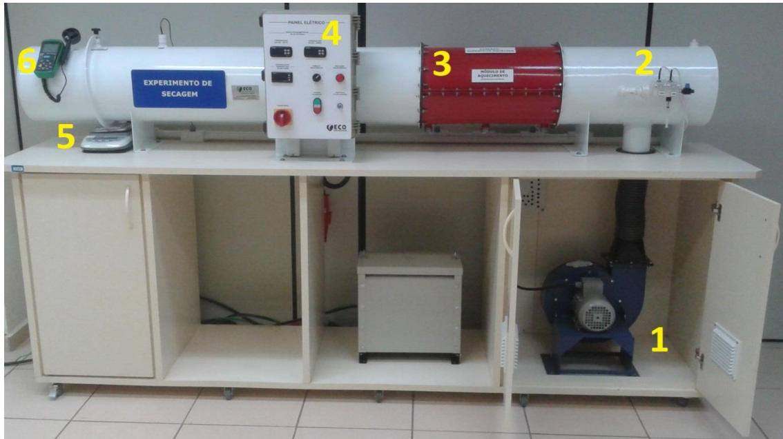
Figura 4. 6 - Módulo experimental de secagem convectiva. (1) Soprador de ar; (2) Psicrômetro; (3) Sistema de aquecimento; (4) Painel de controle; (5) Sistema de pesagem; (6) Anemômetro (BOFFO, 2013).
