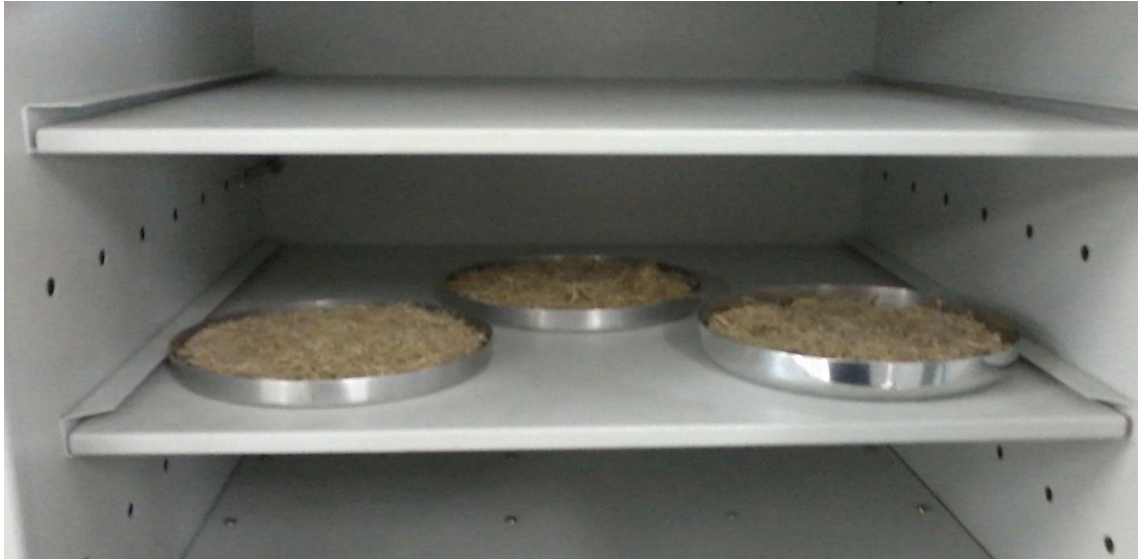
Figura 4. 5 - Secagem do bagaço de cana realizada em estufa (fonte:o próprio).
