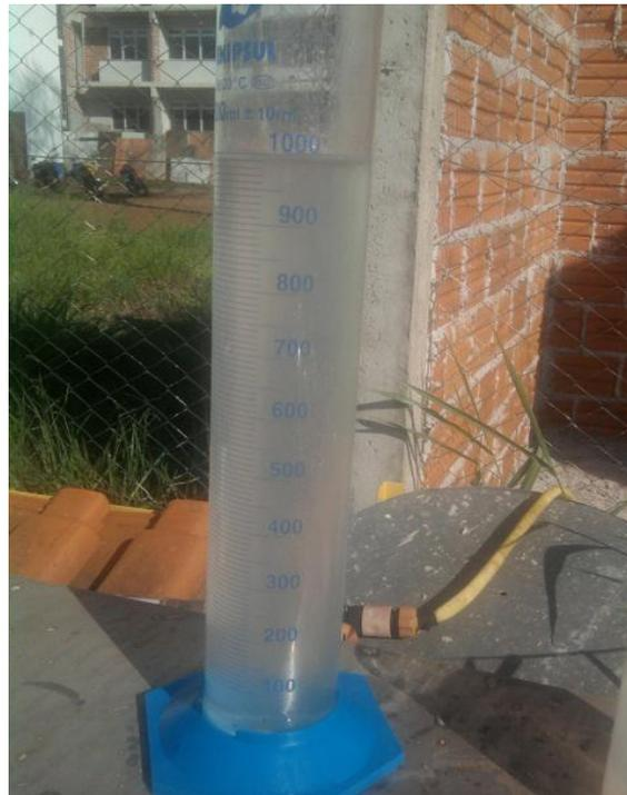
**Figura 4.23** Aspecto do efluente reproduzido após passagem pela caixa de gordura Cipla.
