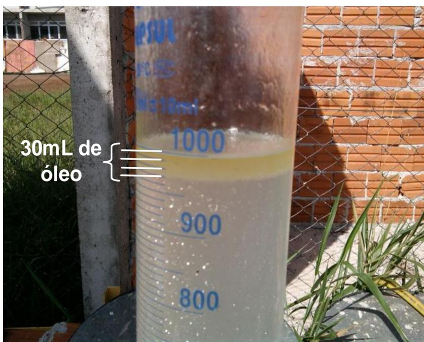
**Figura 4.16** Aspecto do efluente contendo água e óleo após passagem pela caixa de gordura da marca Cipla.
