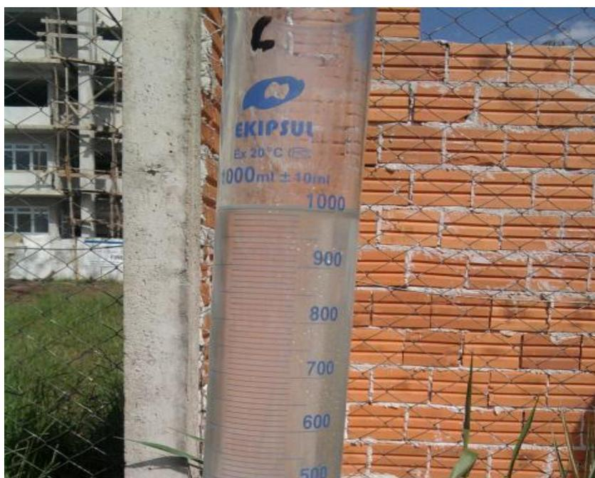
**Figura 4.19** Aspecto do efluente contendo água e arroz após a passagem pela caixa de gordura da marca Cipla.
