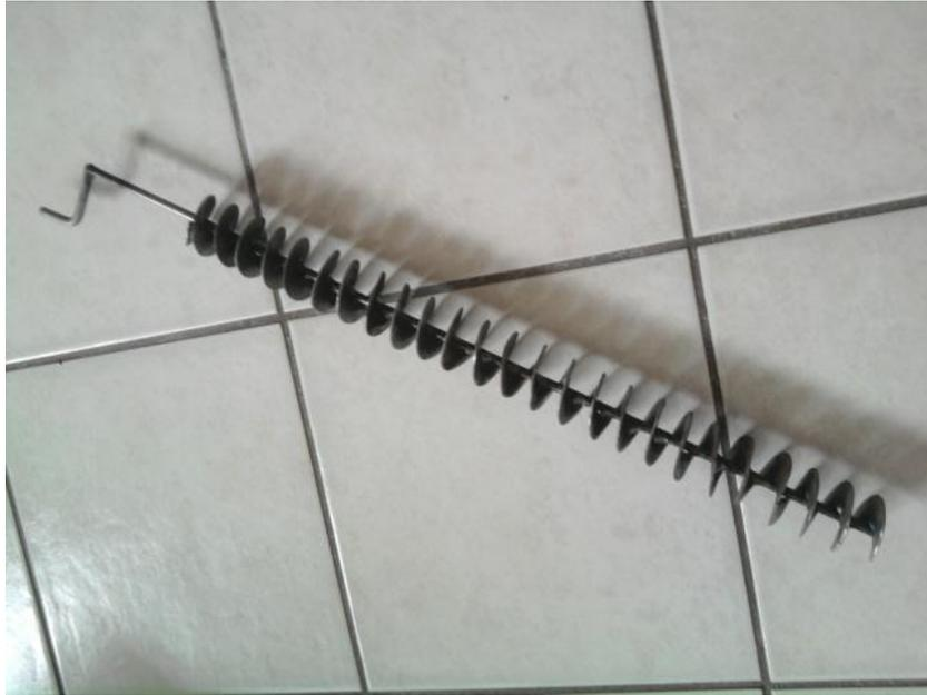
**Figura 4.33** Rosca-sem-fim para coleta dos resíduos sólidos do fundo da caixa de gordura modelo UNIOESTE.
