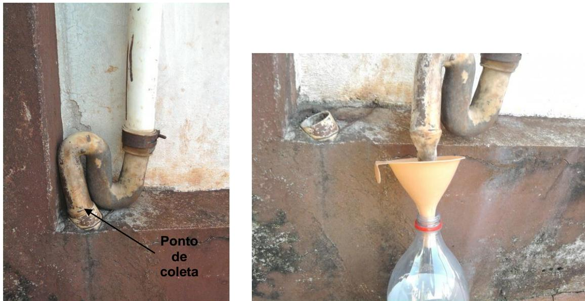
**Figura 4.10** Ponto de coleta do efluente, e coleta de uma amostra do efluente.
