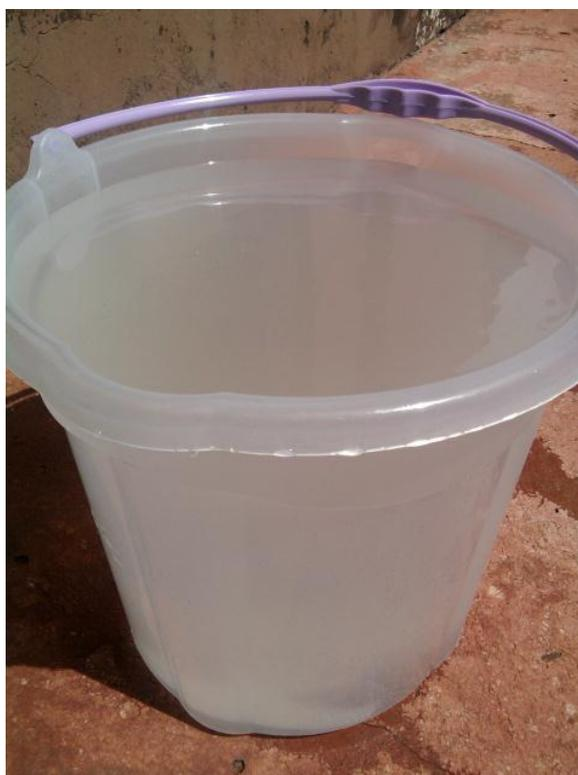
**Figura 4.35** Efluente contendo 1kg de sólidos particulados após passagem pela caixa de gordura modelo UNIOESTE
