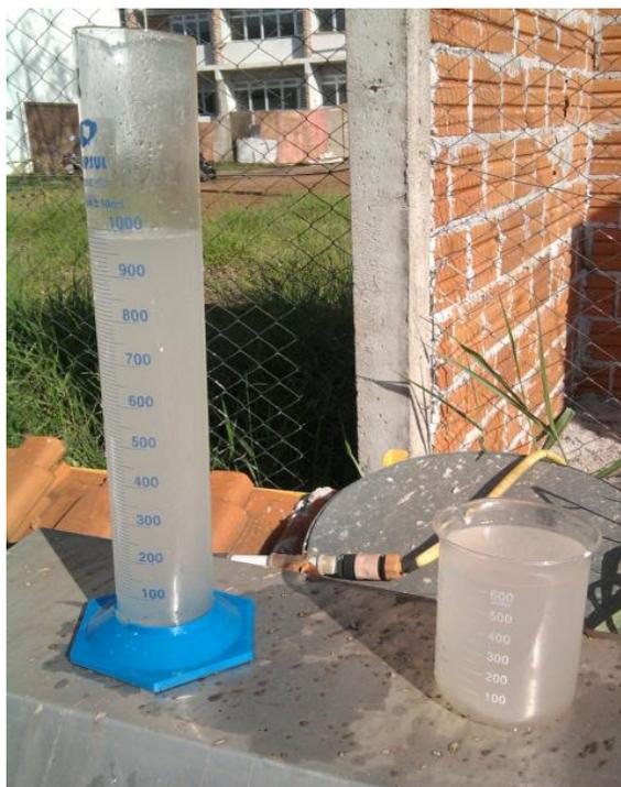
**Figura 4.24** Aspecto do efluente reproduzido após passagem pela caixa de gordura Tigre.
