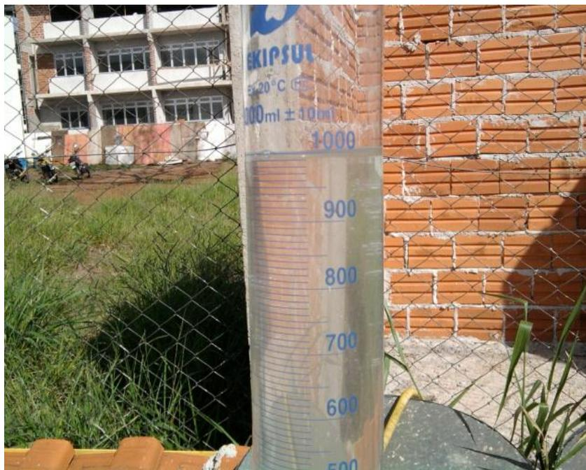
**Figura 4.21** Aspecto do efluente contendo água e arroz após a passagem pela caixa de gordura da marca Durin.
