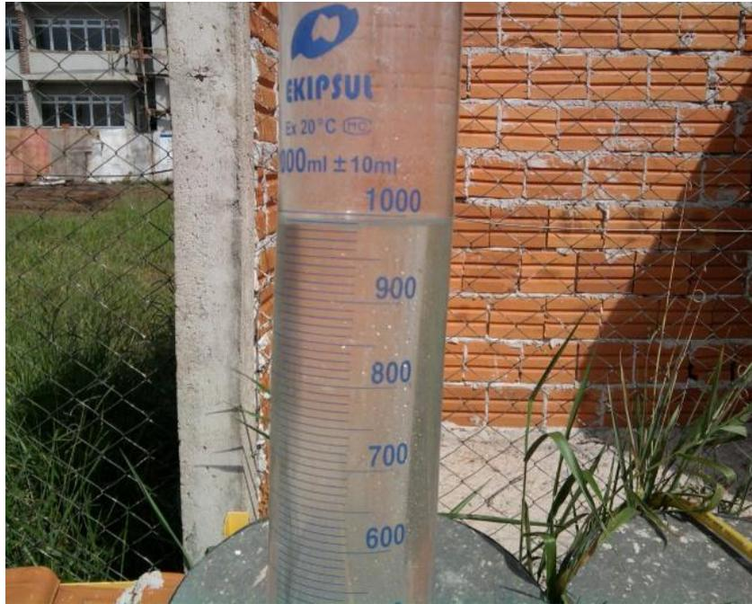
**Figura 4.20** Aspecto do efluente contendo água e arroz após a passagem pela caixa de gordura da marca Tigre.
