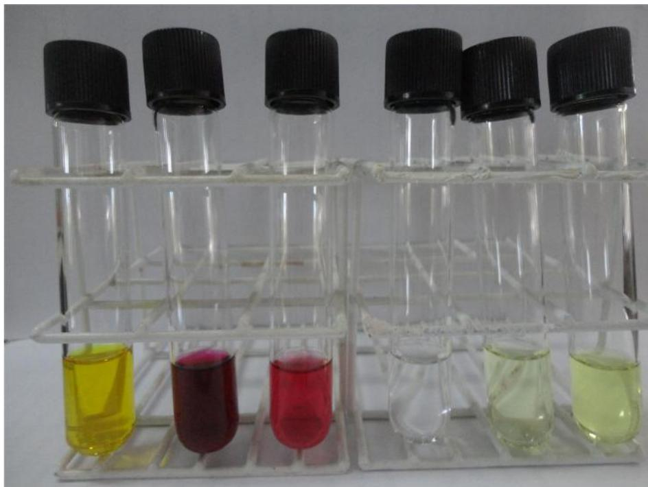
Figura 5. 11: Indicadores usados na análise qualitativa de basicidade na ordem: amarelo dimetil, vermelho neutro, azul de timol, fenolftaleína, 2,4-dinitroanilina e 4-nitroanilina.
