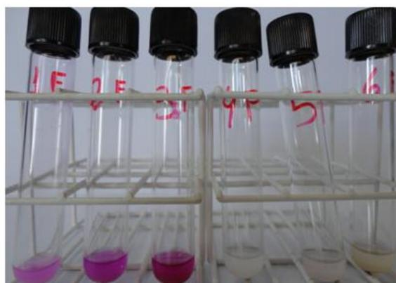
Figura 5. 15: Análise qualitativa de basicidade usando indicador fenolftaleína das amostras KF-Argila 1, KF-Argila 2, KF-Argila 3, Argila 1, Argila 2 e Argila 3.
