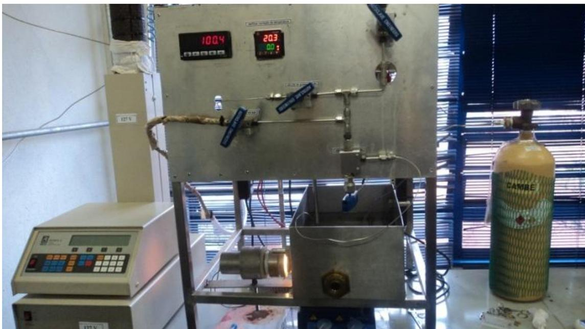
**Figura 4.4** - Módulo experimental para obtenção dos dados de equilíbrio a altas pressões
