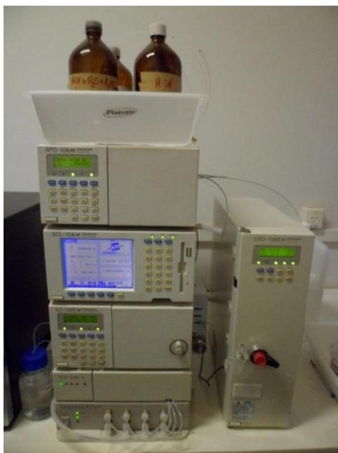
**Figura 4.3** - Cromatógrafo líquido utilizado para as análises do extrato.
