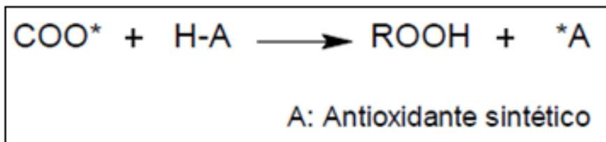
Figura 14 – Mecanismo de ação dos antioxidantes primários sintéticos.
