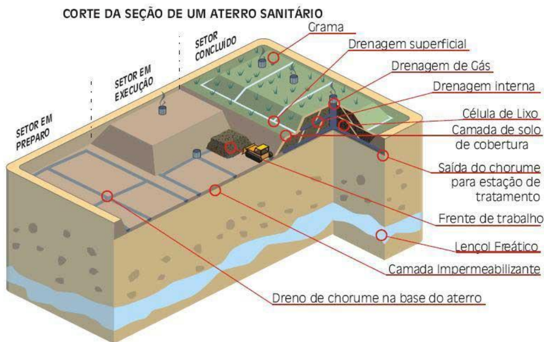
Figura 2. Estrutura básica de um aterro sanitário
