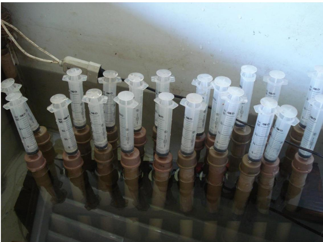
**Figura 3. Condução dos ensaios utilizando reatores em estufa de banho d'água**
