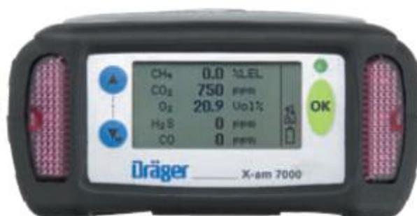
**Figura 14** - Analisador portátil de gases
