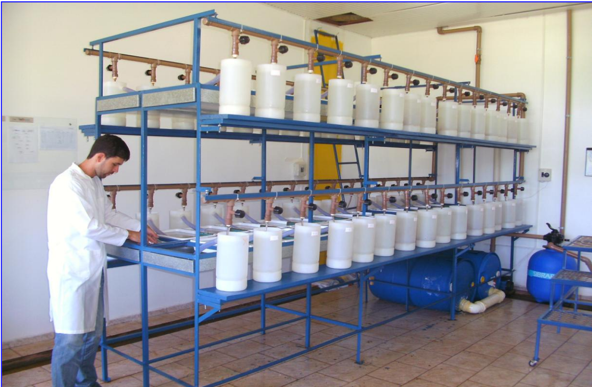
Figura 25. Sistema de incubação de ovos de tilápia do Nilo com filtro mecânico e aquecimento controlado
