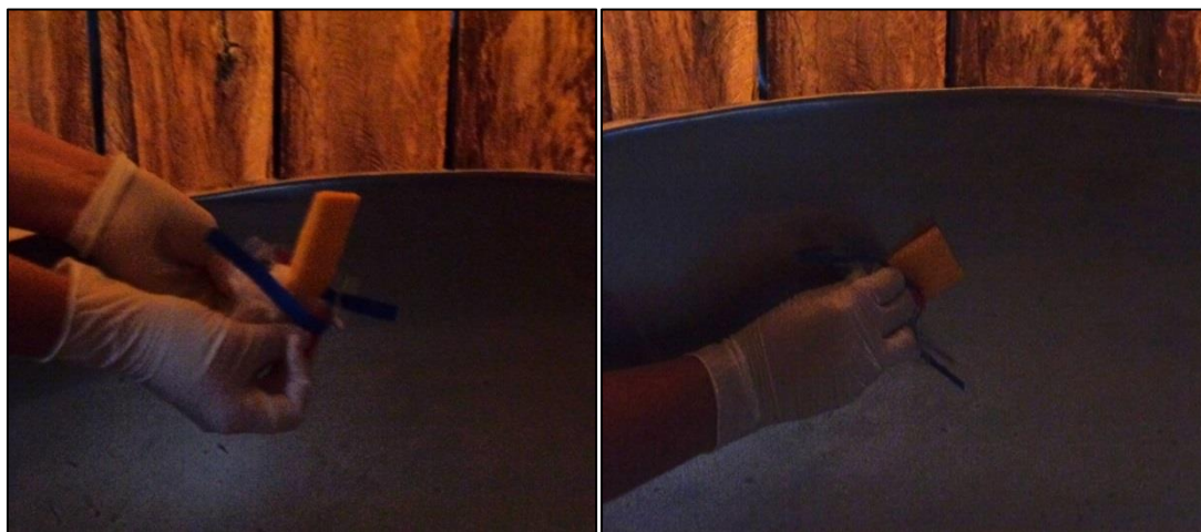
Figura 1 Foto demonstrando abertura e coleta com Swab 3M em superfície de resfriador.
