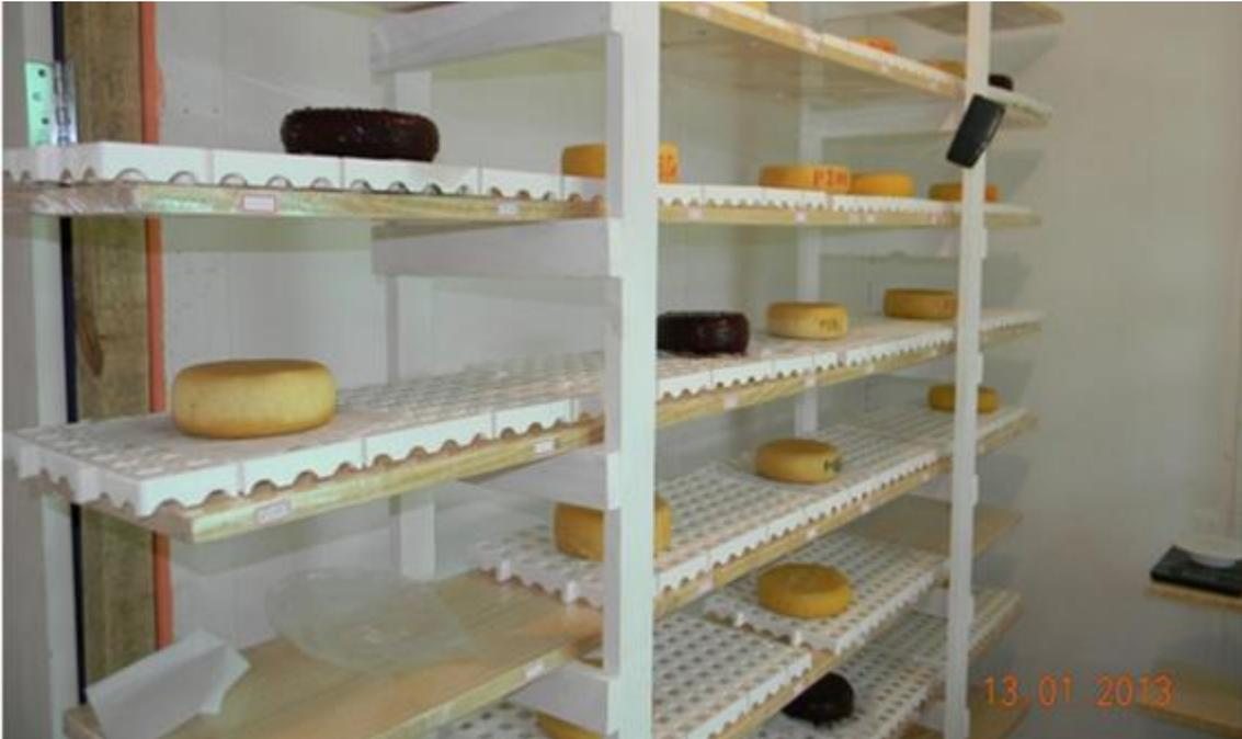
Figura 07. Sala de secagem equipada com prateleiras e estrados sobre estas, com balança digital e um datalogger de registro de temperatura e umidade relativa do ar.
