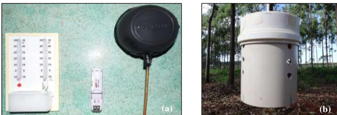
**Figura 2.** (a) Conjunto psicrométrico de leitura visual; termohigrômetro digital com *datalogger*, globo negro; (b) Abrigo micrometeorológico perfurado.
