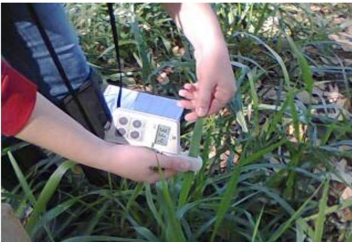
**Figura 4.** Avaliação do índice SPAD com auxílio do aparelho SPAD-502.
