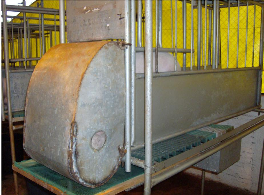
Figura 3. Gaiola de metabolismo com visão externa do comedouro e do coletor de fezes.
