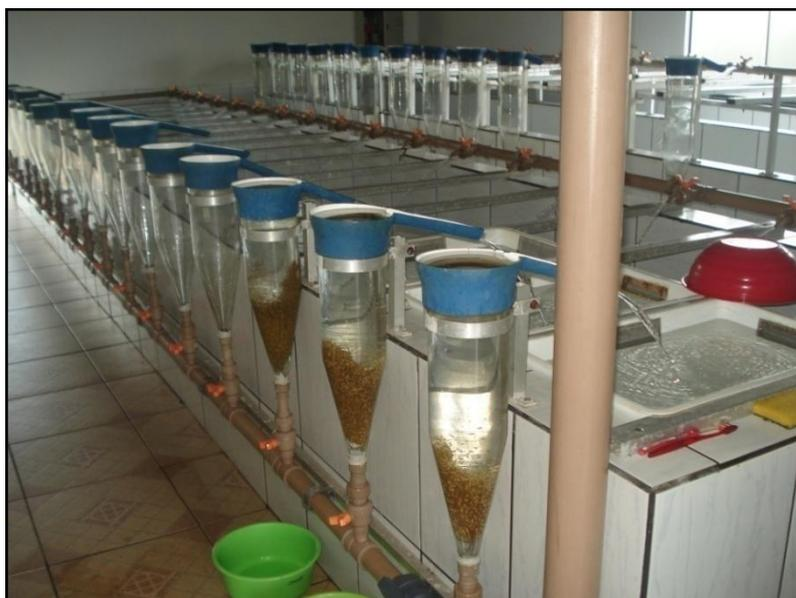
**Figura 3.** Incubadoras utilizadas no laboratório da Piscicultura Sgarbi durante a safra 2011/2012.
