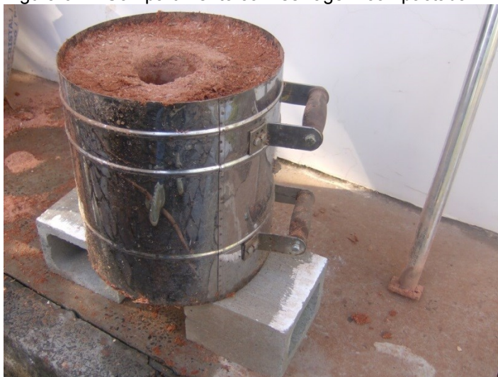
Figura 07 – Compartimento com serragem compactada.
