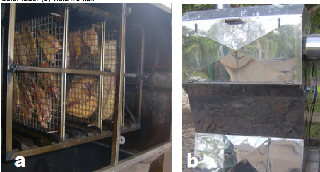
Figura 05 - Defumador Horizontal Rotativo: FD 500- com pacu e armado(a) vista interna do defumador (b) vista frontal.
