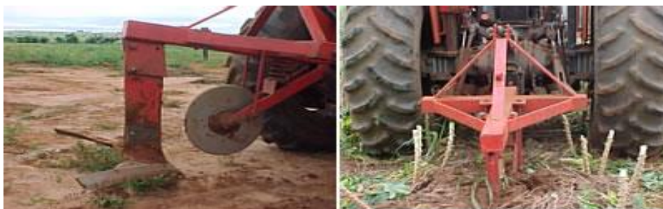
Figura 9. Arrancador de raízes - (esquerda) vista lateral do implemento; implemento em operação (direita) (EMBRAPA, 2005).
