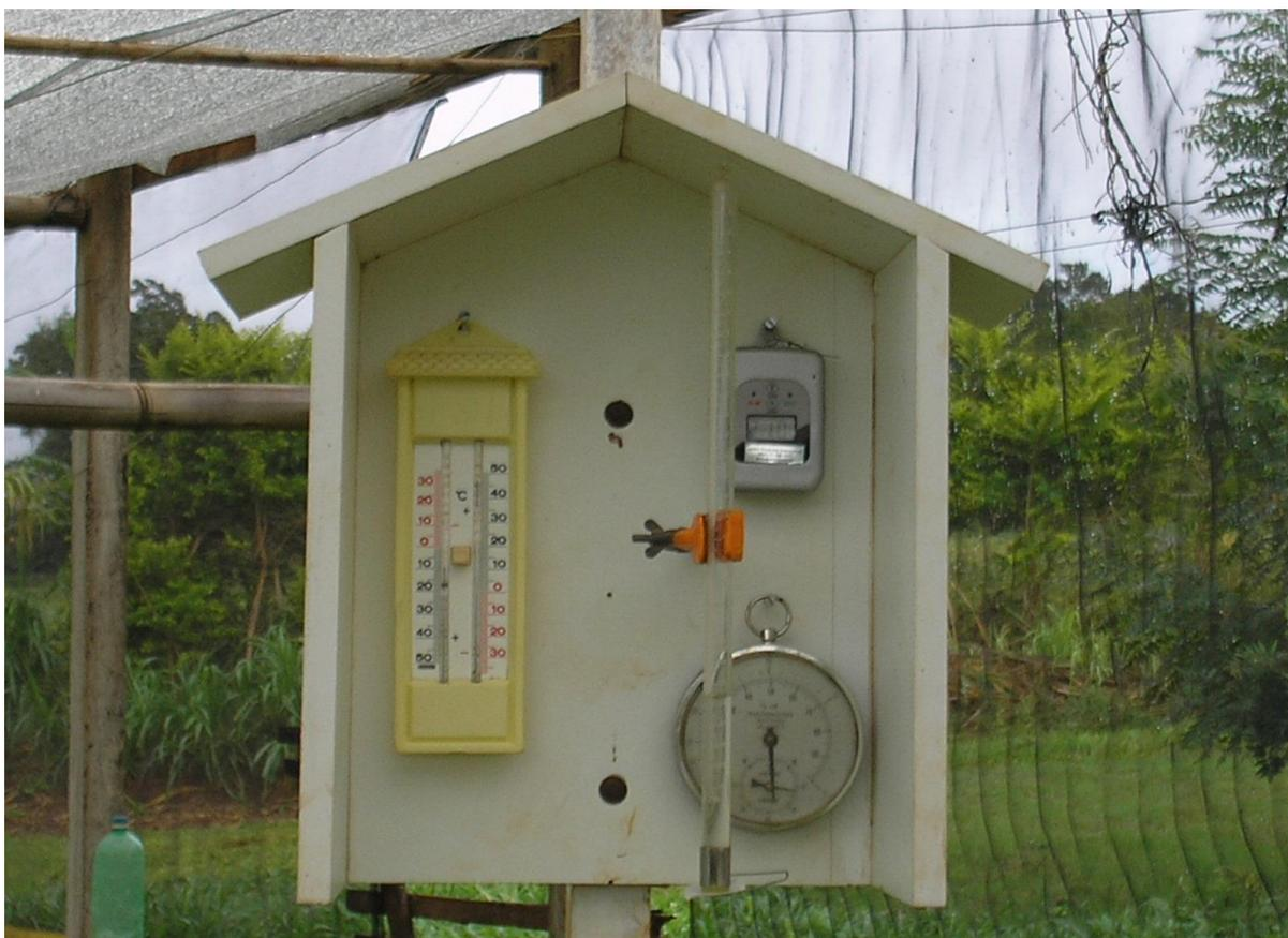
Figura 3: Abrigo Meteorológico com termômetro de máxima e mínima, evaporímetro de Piche, Datalogger. Assis Chateaubriand, PR, 2008.
