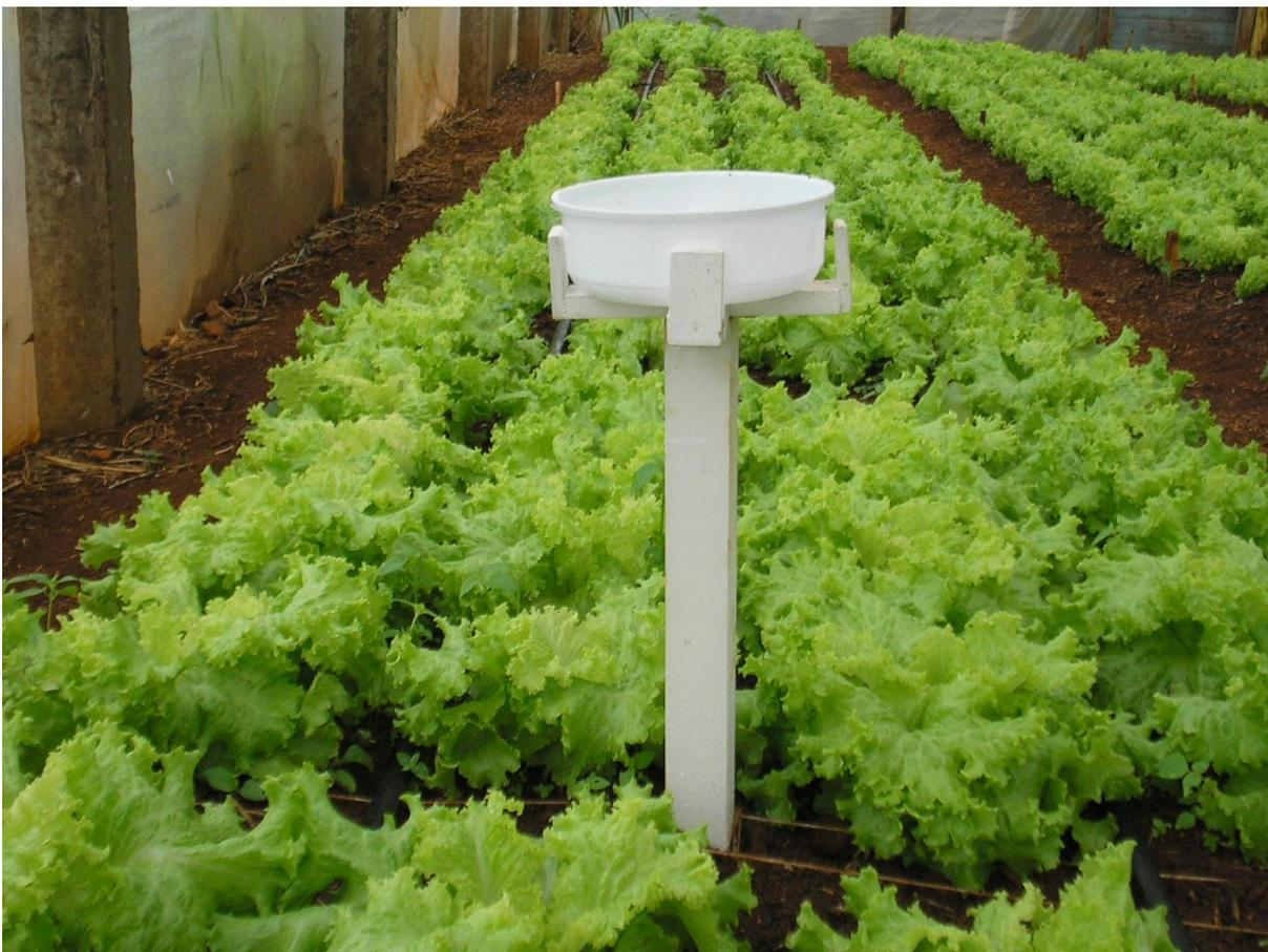
Figura 5: Tanque de evaporação com suporte a 0,4 m de altura. Assis Chateaubriand, PR, 2008.
