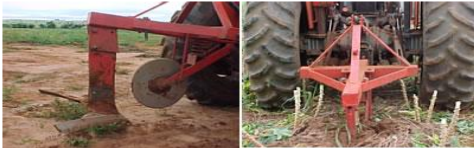
Figura 5. Arrancador de raízes - (esquerda) vista lateral do implemento; implemento em operação (direita) (EMBRAPA, 2005).
