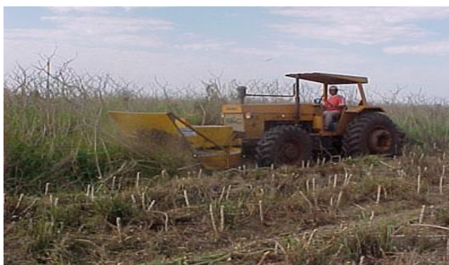
Figura 4. Poda mecanizada de mandioca para realização de colheita, em Rio Brilhante (MS) (EMBRAPA, 2005).
