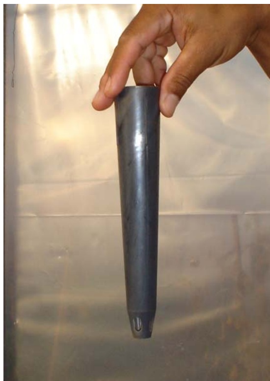
Figura 2. Tubetes de 20 X 5 cm para semeadura e deposição de inóculo.
