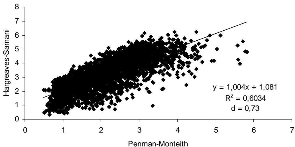
FIGURA 9. Relação entre a Eto diária estimada pelo método de Penman-Monteith – FAO e pelo método de Hargreaves-Samani.
