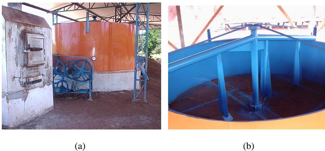
Figura 1. Secador mecânico de camada fixa para café, com sistema adaptado de revolvimento. (a) vista externa; (b) câmara de secagem.
