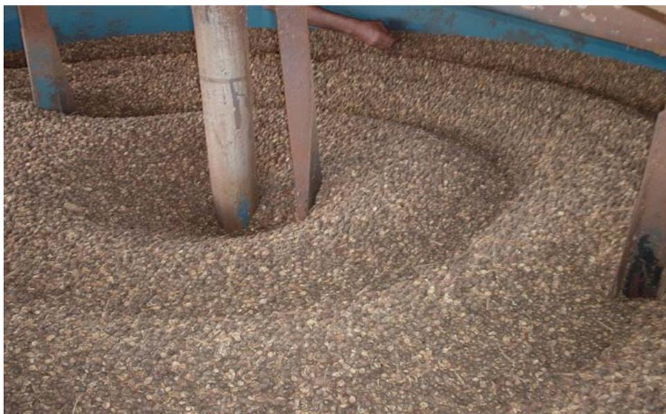
Figura 6. Secador com a capacidade máxima de carga.
