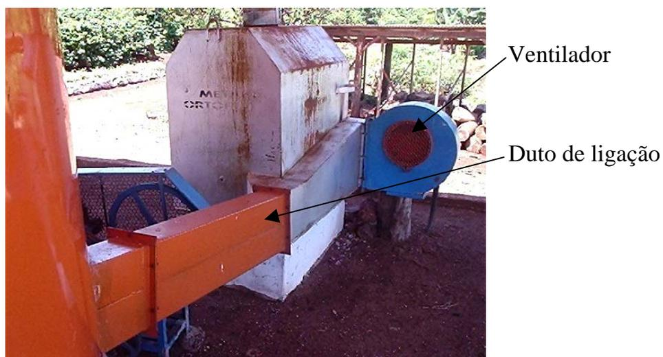
Figura 2. Duto de ligação e ventilador.
