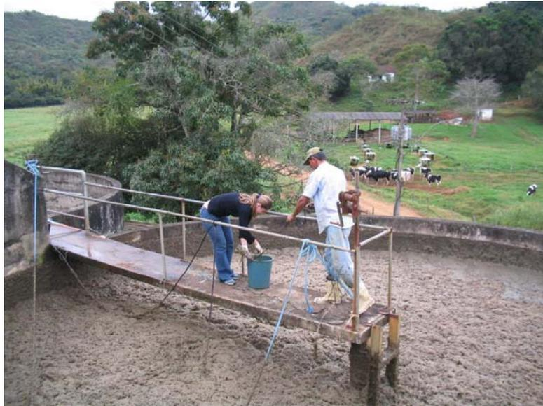
Figura 25. Coleta das amostras no interior do tanque de aeração.
