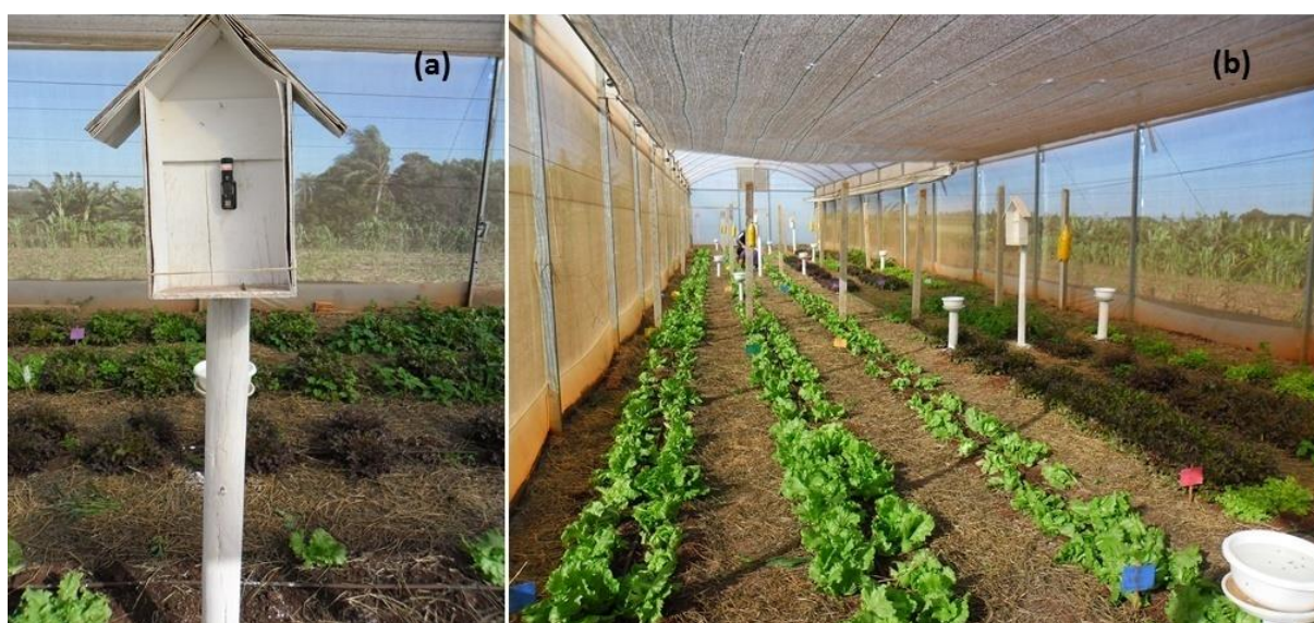
Figura 1. Abrigo meteorológico utilizada (a), distribuição dos datalogger dentro dos ambientes protegidos (b)
